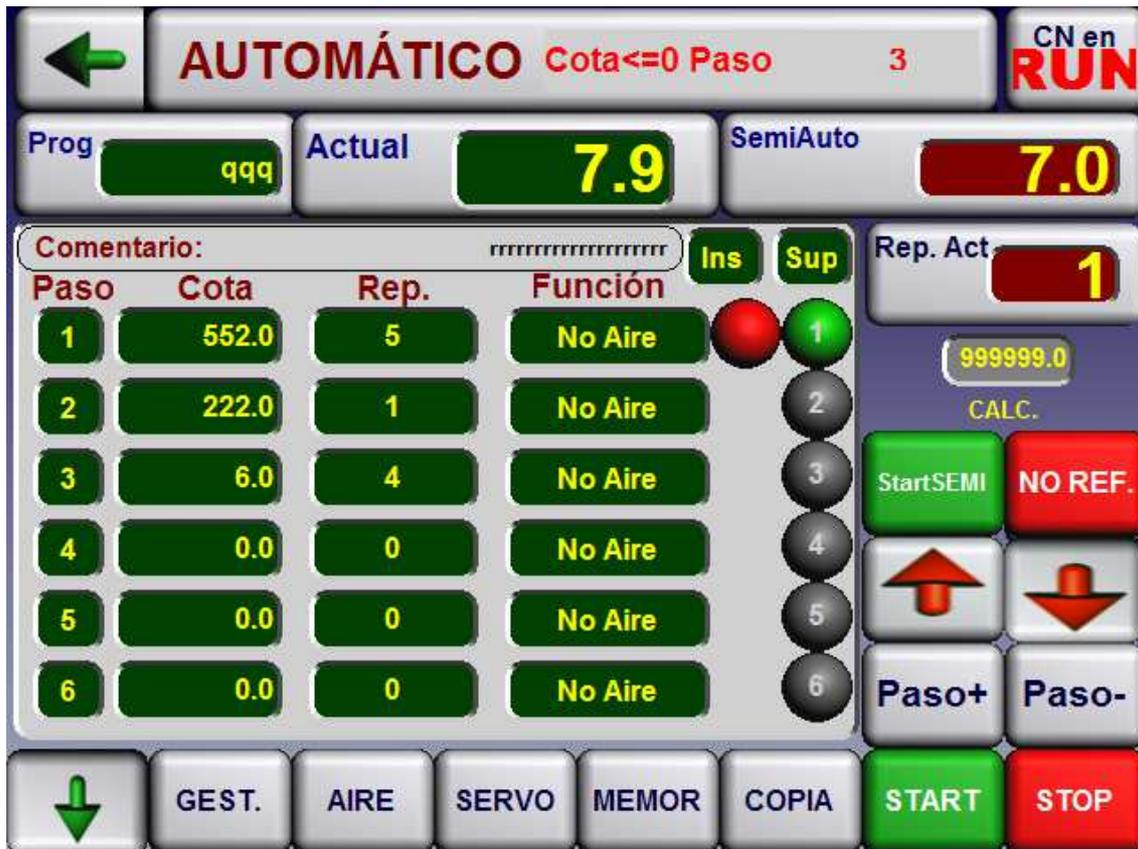
Donde se visualizan todos los pasos del programa y se señala mediante un LED ROJO el paso que hay en ejecución.
