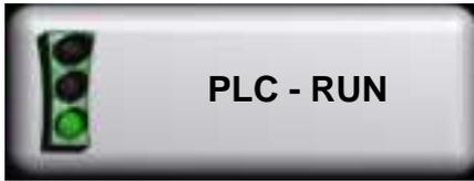
En TEST, permite desactivar el PLC.
